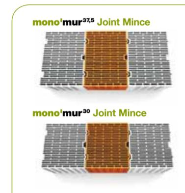
Le joint vertical est réalisé par un emboîtement mâle-femelle, à défaut le joint vertical est effectué au mortier colle déposé sur les parois extérieures des briques.
