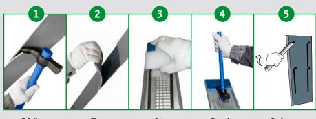
Déclipser sur un côté Tirer sur l'ensemble Oter le bouchon Extraire le système d'aimantation Redresser les armatures Les armatures sont redressées avec un tube afin d'éviter des baïonnettes
